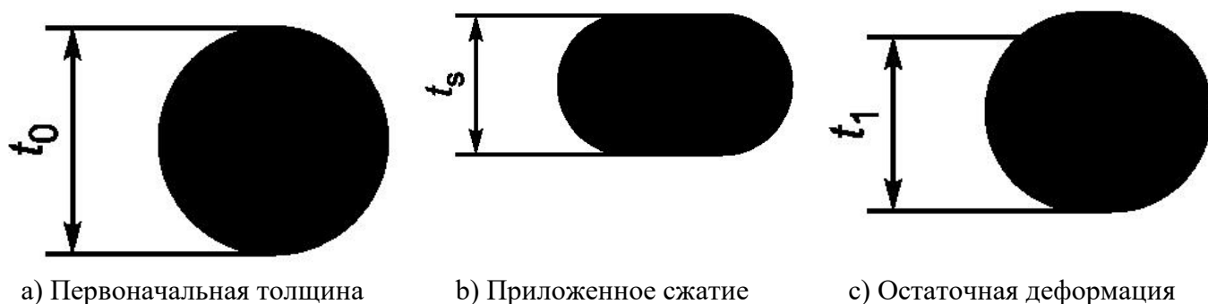
Рисунок 10 - Остаточная деформация при сжатии уплотнительного кольца
